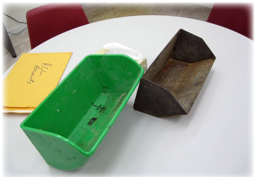
Bild 2: Aus Stahl hergestellter Becher im alten Stil und Becher des Typs CC
