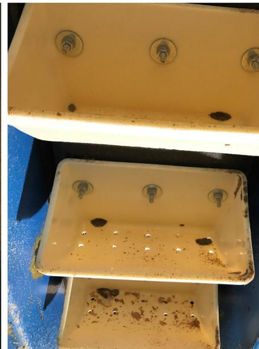
**Informations sur l'élevateur :** *Élevateur à large sangle en PVC (250 mm de largeur) perforée à intervalles de 203 mm pour les godets à événements en uréthane CC-S 9x5. Poulie autonettoyante à ailettes*
